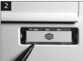
In beide unteren Kerben drücken. Um Lackbeschädigung zu vermeiden keine Metallgegenstände verwenden!
