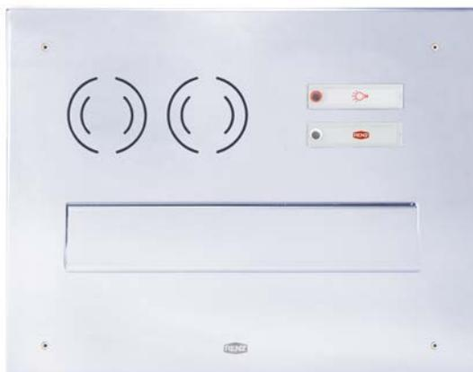
Elegante flache Frontplatte mit nur 2 bzw. 2,5 mm Dicke. Verschraubung der Front mit den Kästen mittels Kunststoff-ecken, auch ohne Frontüberstand verbaubar. Auf Wunsch mit RS1001-Abschlussrahmen und integriertem Regenabweiser lieferbar. Erhältlich aus Galvan-Stahl, Aluminium oder Edelstahl V4A. Alternativ aufklappbar lieferbar.
